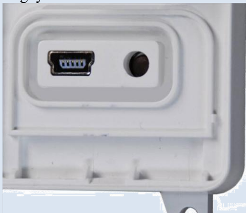
AVS74: USB Mini-B csatlakozó, kioldó gomb
